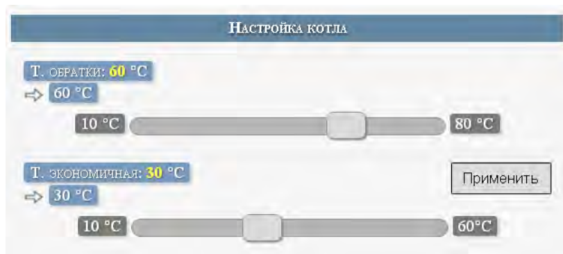
Рис.9.5. Вкладка настройки котла.
